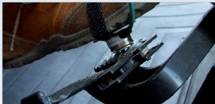
Запись дополнительного параметра - усилия нажатия на педаль тормоза - при проведении дорожного тормозного испытания.
