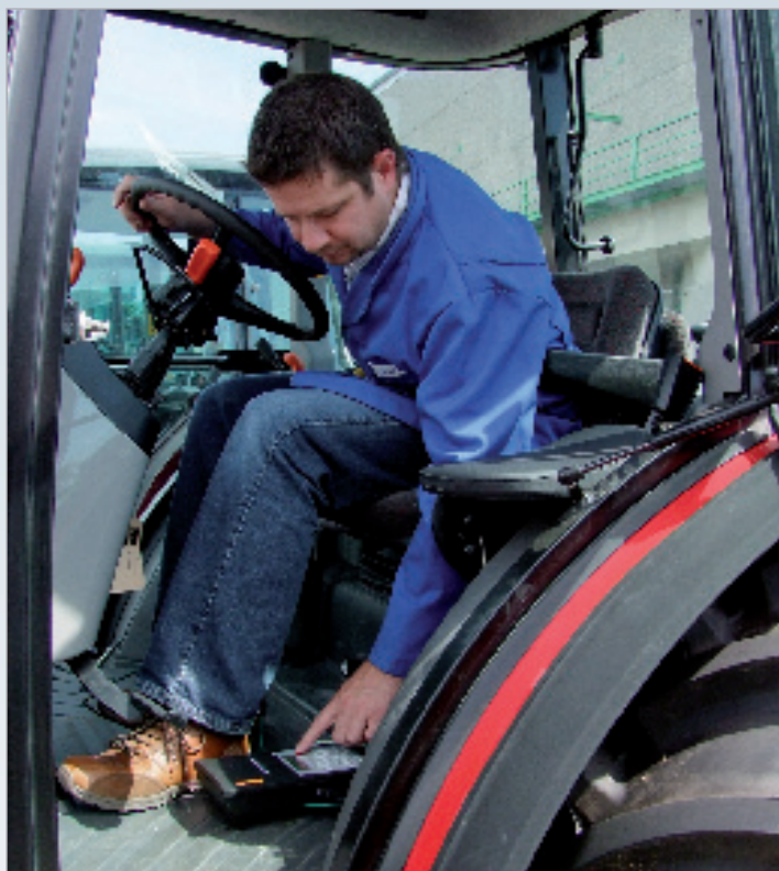
При проведении измерения прибор нужно просто положить на пол транспортного средства.
