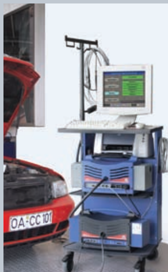
Измерение дымности легкового автомобиля
