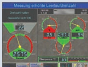
Отображение процедуры испытания (специфичной для страны применения), позволяющее одним взглядом охватить всю важную информацию
