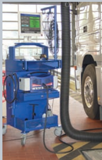
Измерение дымности грузового автомобиля
