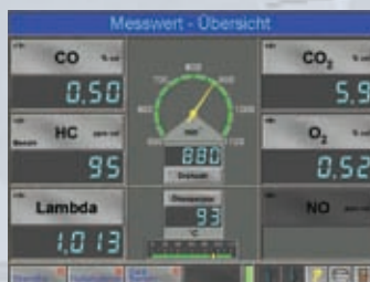
Обзор измеренных величин. Функциональное отображение всех измеренных величин (с частотой вращения и температурой масла, а также организуемым по заказу измерением NOx)
