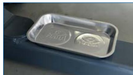
Магнитный лоток для гаек крепления колес.
