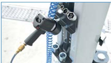
Держатель пневмоинструмента с отсеком для хранения удлинителей опорных площадок.
