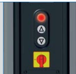
Достигнута верхняя конечная позиция или сработал световой барьер. Возможен только спуск. Синий цветовой сигнал клавиши спуска.
