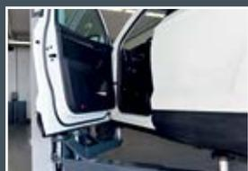
Увеличенный угол открывания дверей для комфортного выхода из автомобиля за счет стоек, развернутых на 45° (тип "А").
