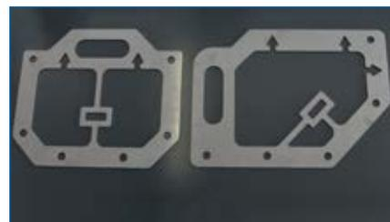
Шаблон для сверления отверстий для безошибочного монтажа.
