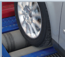
Стенд проверки спидометров
