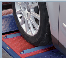
Стенд проверки демпфирующих свойств подвески
