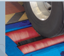
Силовой роликовый тормозной стенд
