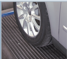
Стенд проверки бокового увода ("схождения") колес
