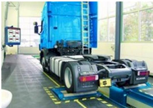
Роликовые тормозные стенды для грузовых автомобилей
