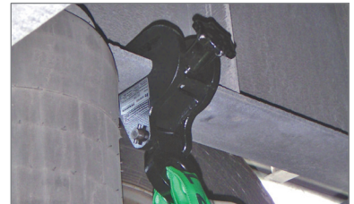
Фиксирующие зажимы Для закрепления ремня симулятора на раме автомобиля.
