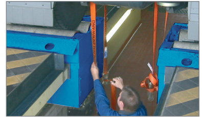
Симуляторы нагрузки MLS 2100/2200 Двухнаправленный гидроцилиндр для фиксированного или мобильного (с помощью рельс) монтажа.
